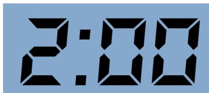
\*\* La minuterie de surpassement est un compte à rebours, la valeur indiquée est le temps restant. Quand la minuterie expire, l'appareil revient aux réglages en vigueur avant l'activation du surpassement. L'appareil continue à prendre des mesures pendant le surpassement, afin de pouvoir effectuer les ajustements de ventilation nécessaires à l'expiration de la minuterie.
