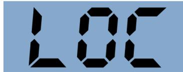
Il est possible de désactiver temporairement le verrouillage en maintenant la flèche montante pendant 10 secondes. On peut alors apporter des modifications au contrôleur (humidité, surpassement, vitesse du ventilateur). Le verrouillage se réactive après 10 secondes d'inactivité.
