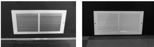
Quand la circulation entre les pièces du sous-sol est restreinte ou inexistante (s'il y a des murs ou des partitions), posez une grille de 8 x 10 po (ou toute autre configuration produisant une superficie d'au moins 515 cm<sup>2</sup> [80 po<sup>2</sup>]) au bas de la porte ou du mur pour éviter que l'air stagne dans ces pièces. Sinon, les portes intérieures doivent rester ouvertes. Cette mesure garantit que l'air aspiré dans le système Humidex provient de l'ensemble du sous-sol.
